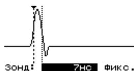
Режим растяжки любой точки рефлектограммы в больших пределах позволяет отсчитать расстояние до дефекта с высокой точностью.
