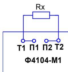
Рисунок 6.2 - Схема измерения сопротивления без исключения влияния соединительных проводов
