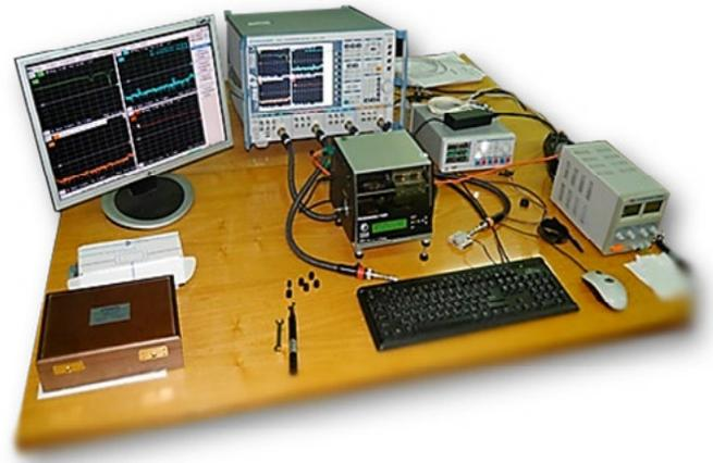
*Рабочее место для измерения шумовых параметров транзисторов*
