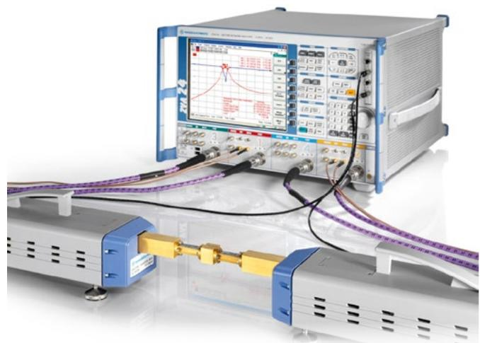
Многопортовые устройства (например, ответвители) могут тестироваться с использованием 3 или 4 преобразователей. Схема измерений может строиться на базе анализатора R&S®ZVA, внешнего генератора (например, R&S®SMF100A) и преобразователей для каждого из измерительных портов.
