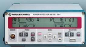
Измеритель отраженной мощности
