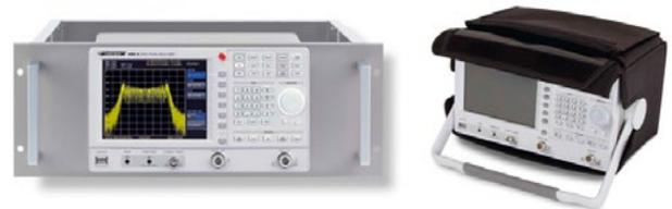
Управление прибором можно производить как непосредственно, с помощью кнопок на передней панели, так и дистанционно, с использованием шин RS-232/USB/GPIB/LAN. Соответствующие интерфейсные платы располагаются, как обычно, на задней панели анализатора. Для их установки нет необходимости отправлять прибор в сервисный центр. Это легко осуществляется своими силами на рабочем месте.
