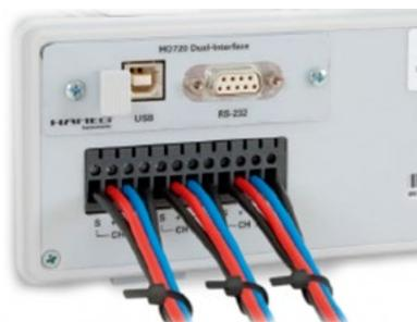
В стандартной комплектации приборы оснащены интерфейсами RS-232/USB (опция H0720). Дополнительно в приборы можно установить интерфейсные платы Ethernet/USB (опция H0730) или IEEE 488 (GPIB) (опция H0740). Дистанционное управление обеспечивает доступ практически ко всем функциям, имеющимся на передней панели. Для программирования приборов используются стандартные SCPI-команды.
