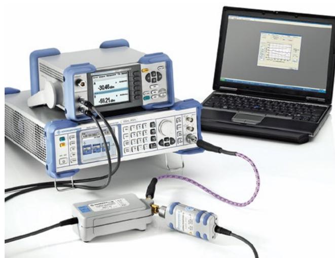
Измерительная установка для калибровки преобразователя мощности NRP-Z55
