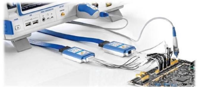
Автоматическое выравнивание компенсирует задержку между разъемами при подключении пробников аналоговых и цифровых каналов. Даже с включенными цифровыми каналами осциллографы обеспечивают скорость обновления экрана свыше 200 тысяч осциллограмм в секунду.
