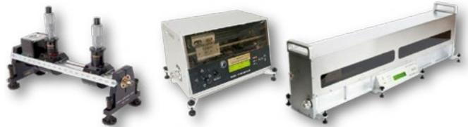
Программируемые тюнеры, по сравнению с ручными, имеют значительное преимущество, за счет повторяемости результатов, поскольку выставление зондов (в случае использования ручного тюнера) будет зависеть от оператора, от механической стабильности конструкции тюнера, от плавности перемещения зондов и от достижимой точности регулировки.
