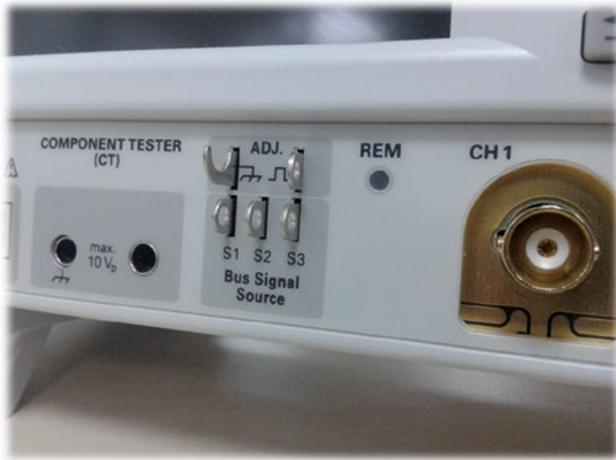
Контакты **Bus Signal Source** являются источниками специальных сигналов (сигналов последовательных шин, случайных битовых комбинаций, сигнал счетчика) с соответствующими настройками.
