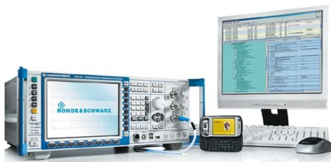
ВЧ-параметры, учитывающие требования будущего Диапазон частот до 3,3 или 6 ГГц с полосой ПЧ 40/80 МГц анализатора/генератора.
