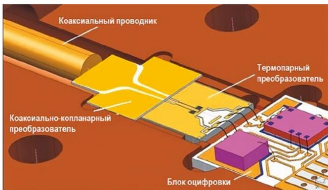
Входной каскад ВЧ-тракта с коаксиально-копланарным преобразователем
