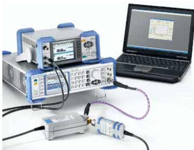
*Измерительная установка для калибровки преобразователя мощности NRP-Z55*
